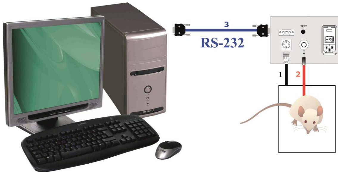
Figura 11 Conexiones del equipo.
