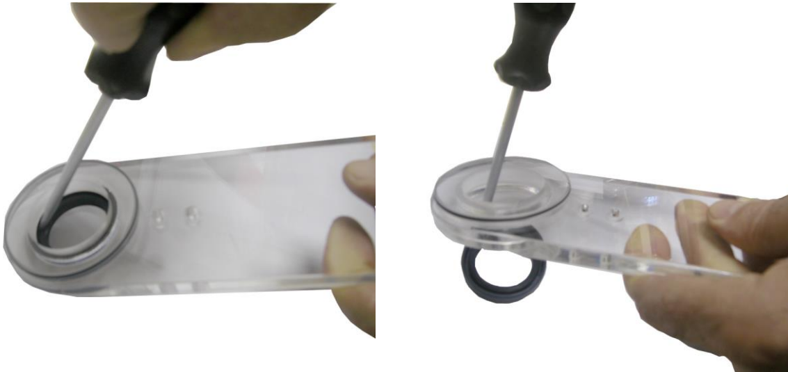
Figura 27. Extracción del retén.
