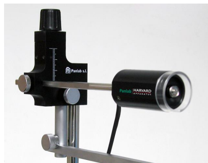
Figura 12. Fijación del transductor.
