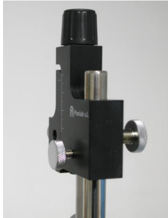
Figura 10. Fijación del tornillo micrométrico
