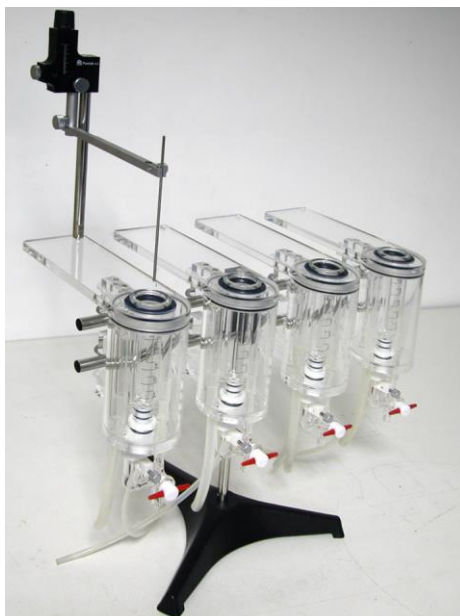
Figura 1. Montaje de 4 módulos de baño de órganos LE 11100.
