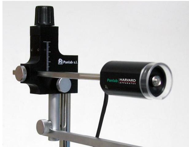
Figura 24. Conjunto MICROPOSICIONADOR / PORTATEJIDOS / TRANSDUCTOR
