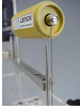
Figura 22. Fijación del Tejido al Transductor.
