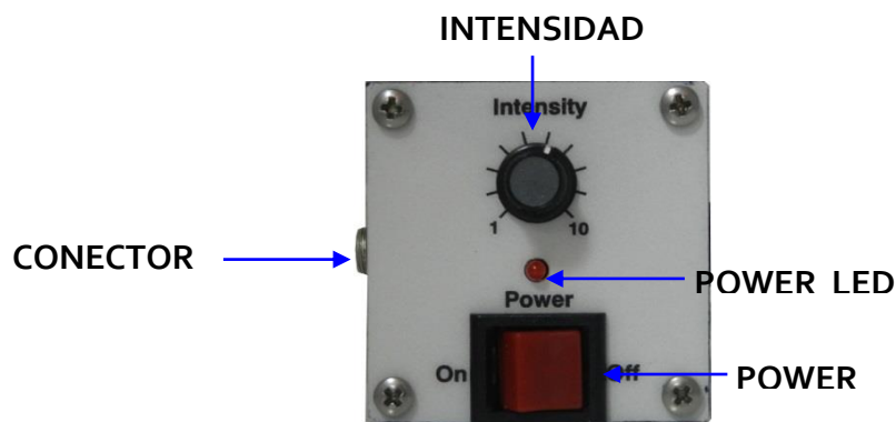
Figura 3. Caja de control
